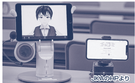
テレボは教室内に置いたカメラを病室など遠隔から操作できるロボットシステム
